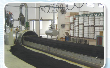
⑦ Depthwise Heat Setting » 橫目定型
