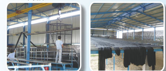
⑧ Resin Treatment (Optional products) » 樹脂添加 (部分產品)
