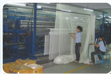
④ Checking & Mending » 巡補網片
