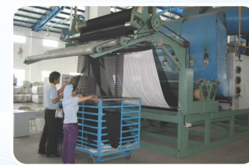
⑦ Lengthwise Heat Setting » 直目定型
